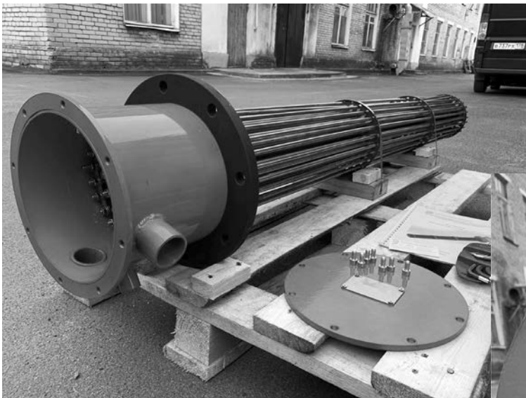
Блок для подогревания масла на 100 кВт
