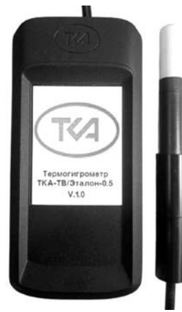
Рис. 4. Термогигрометр эталонный ТКА-ТВ/Эталон
