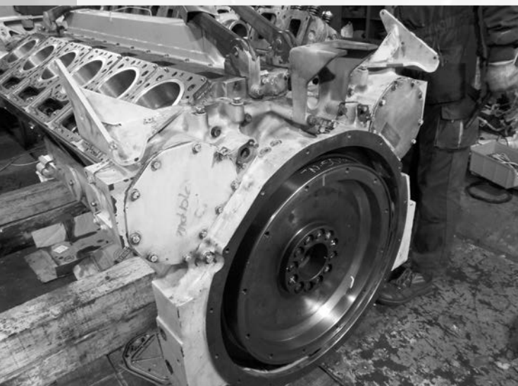
Ремонт мотора CAT 3512
