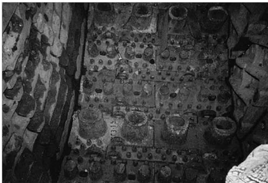
Рисунок 5. Испытание каблучковой футеровки на опытной мельнице DхL=7,0х2,3 м.
