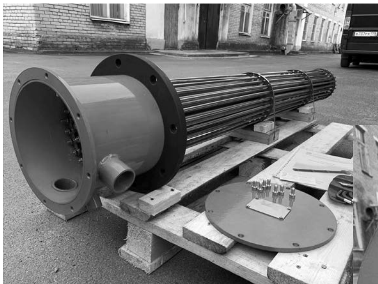
Блок для подогревания масла на 100 кВт
